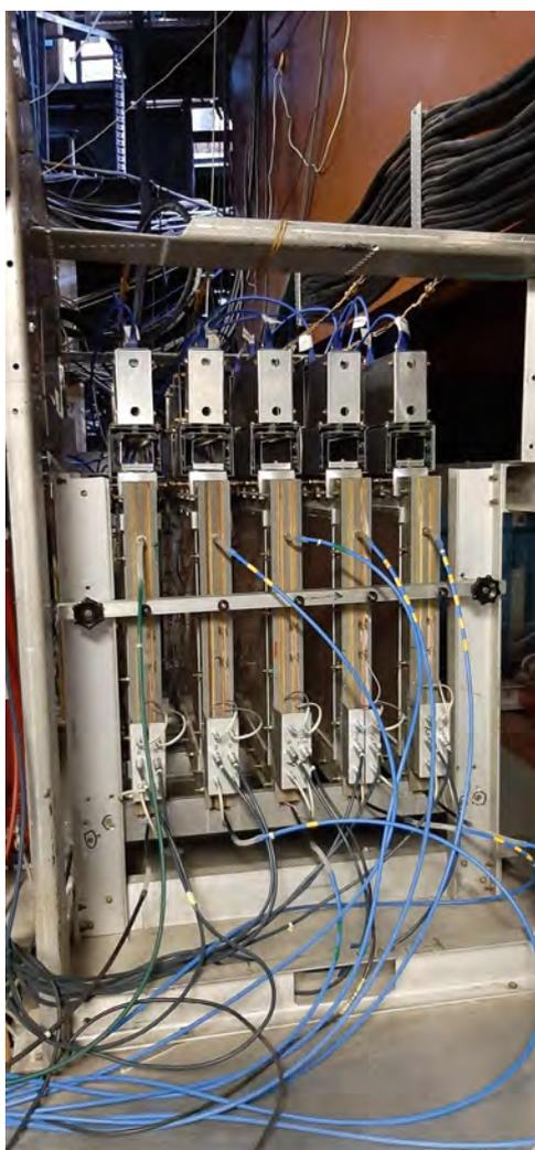
Рис. 1. Группа камер РС  $40 \times 60$  на выдвинутой из магнита платформе. Вид со стороны подсоединения газовых трубок и высоковольтных кабелей. Сверху – комплекты электроники X-плоскостей в экранах. Над платформой виден коричневый экран магнита установки.
