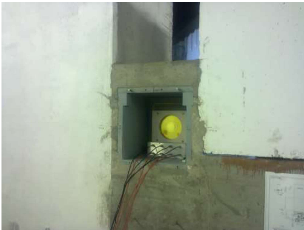
Рис 5. Установленная в окне блока биологической защиты по оси пучка перед водным фантомом ионизационная камера
