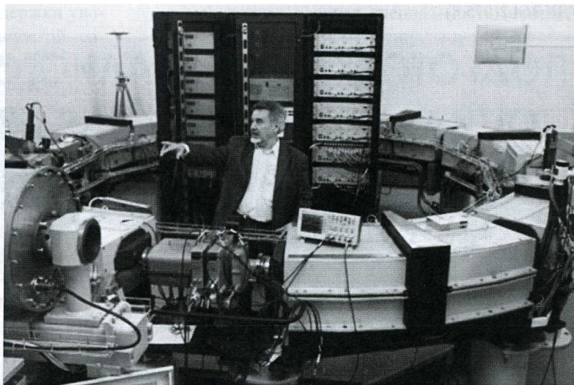
Рис. 4. Компактный ускоритель протонных пучков для лечения онкологических заболеваний, созданный в ЗАО «ПРОТОМ» (Протвино)
