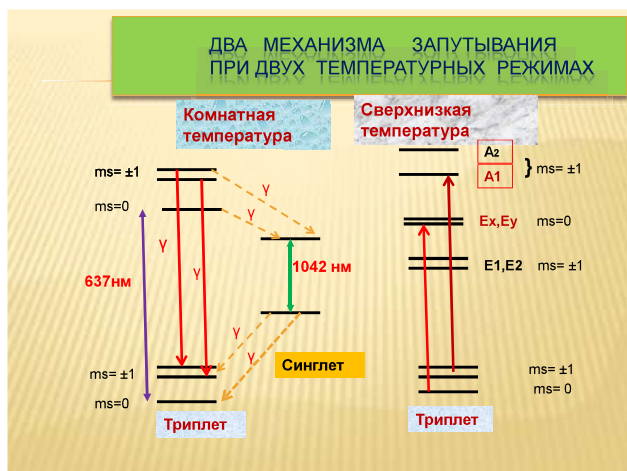
Рис. 9. Наблюдаемые спиновые уровни возбужденного состояния и оптические переходы при комнатной и криогенной температурах
