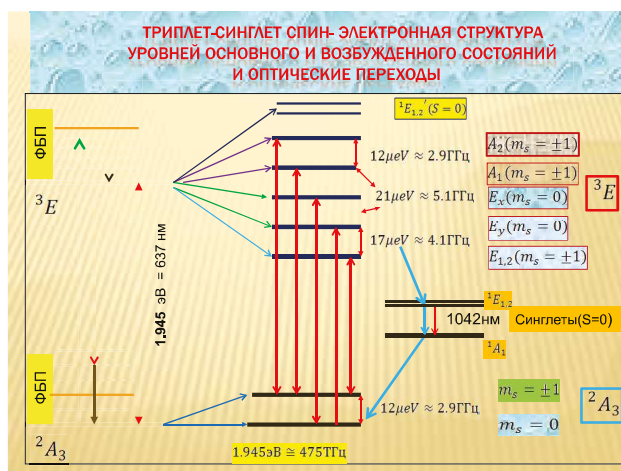
Рис. 2. Структура спин-электронных уровней и оптическое возбуждение NV-центра, представленное 5-ю оптическими переходами (два уровня вырождены) [3]
