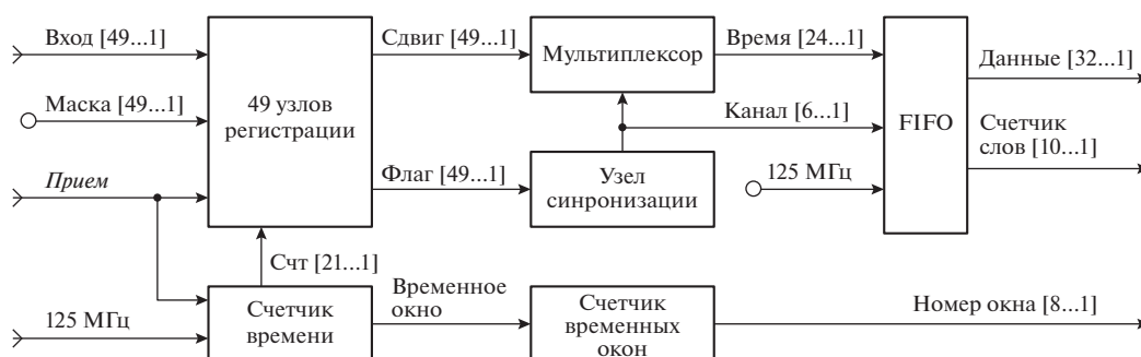
Рис. 5. Структурная схема времяцифрового преобразователя модуля МТ-48.
