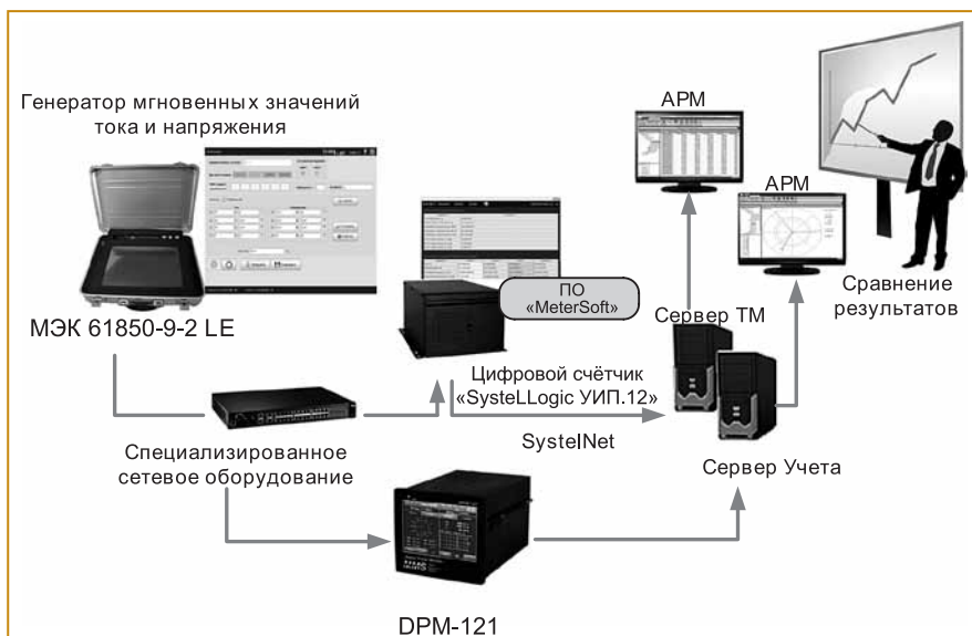
Рис. 5 Схема стендовых испытаний прибора SystelLogic УИП.12
