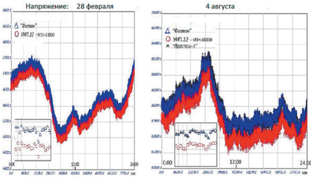
Рис. 10. Графики зависимости напряжения по трём каналам измерений
