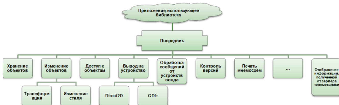
Рис.2 Взаимодействие графической библиотеки и клиентских приложений SCADA «Систел»
